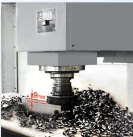
● 9mm Depth Face Milling (50#)
