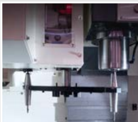
■ Время смены «инструмент- инструмент»: 1,8 сек
