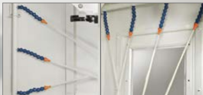
■ Система верхнего полива для смыва стружки внутри кабины станка
