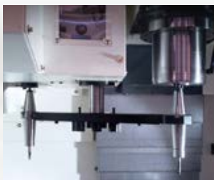
■ Время смены «инструмент- инструмент»: 1,8 сек
